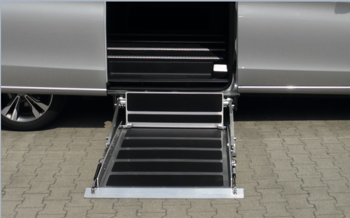
Die automatische Abrollklappe und die großzügige Plattform sorgen für zusätzliche Sicherheit.
