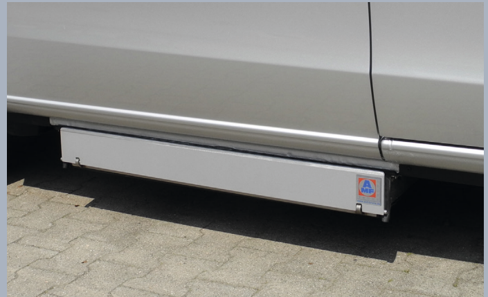
Der ultraflache Kassettenlift garantiert die größtmögliche Bodenfreiheit.
